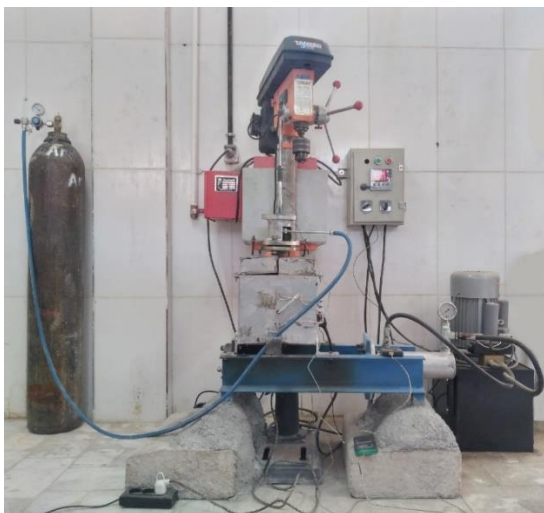
شکل ۲ دستگاه ریخته گری اغتشاشی تحت گاز خنثی
