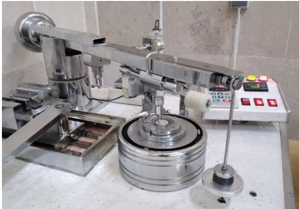
شکل ۶. شماتیک دستگاه سایش
